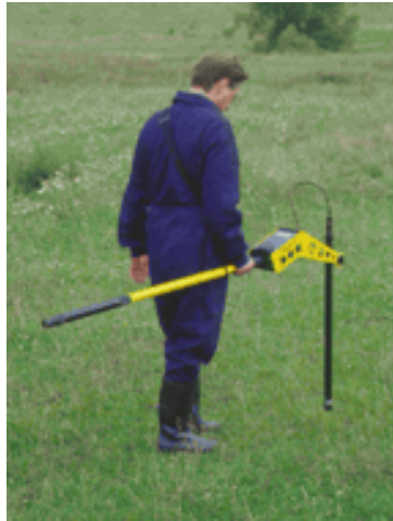
Слика 3. Детекција феромагнетних материјала са уређајем који користи магнетометарски принцип рада
