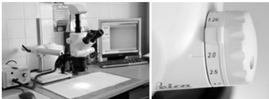
Слике 4а и 4б – На слици 4а приказан је микроскоп за анализирање самолепљивих фолија, тзв. „парафинских рукавица“, повезан са компјутером. На слици 4б приказан је део микроскопа помоћу којег подешавамо увећање.
