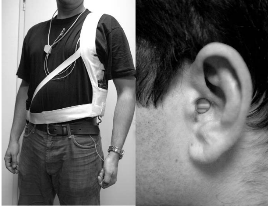
Бежични прибор који се носи испод одела, са микрофоном на крагни и „буба” сакривена у ушној шкољци
