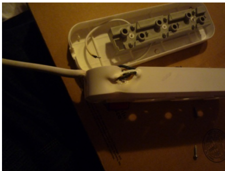
Слика 6 – Оштећења настала на продужном каблу турске производње (услед појаве „вреле тачке“ на лошем електричном контакту унутар кућишта компоненте)
