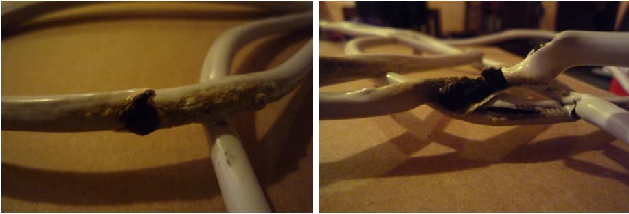
Слика 5 – Оштећења настала на продужном каблу кинеске производње (услед струјног преоптерећења проводника смањеног попречног пресека)
