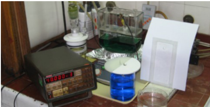
Слика 3. Лабораторијска апаратура за електрохемијско таложeње металних филмова: извор константне струје (1), кадица са електролитом за електрохемијско таложeње никла (2), магнетна мешалица са регулацијом температуре (3), десиливана вода за исцрање након таложeња (4)
