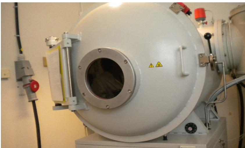
Слика 1. Уређај за визуелизацију латентних трагова папиларних линија помоћу вакуумског таложења метала (Vacuum Metal Deposition – VMD) 5
